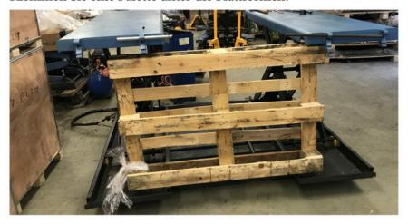
**Schritt 3:** Fahren Sie die Hebebühne soweit runter bis die Plattformen sicher auf der Palette aufliegen.
