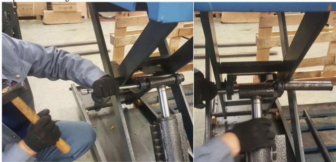
**Schritt 7:** Splint oder Bolzen entfrenen
