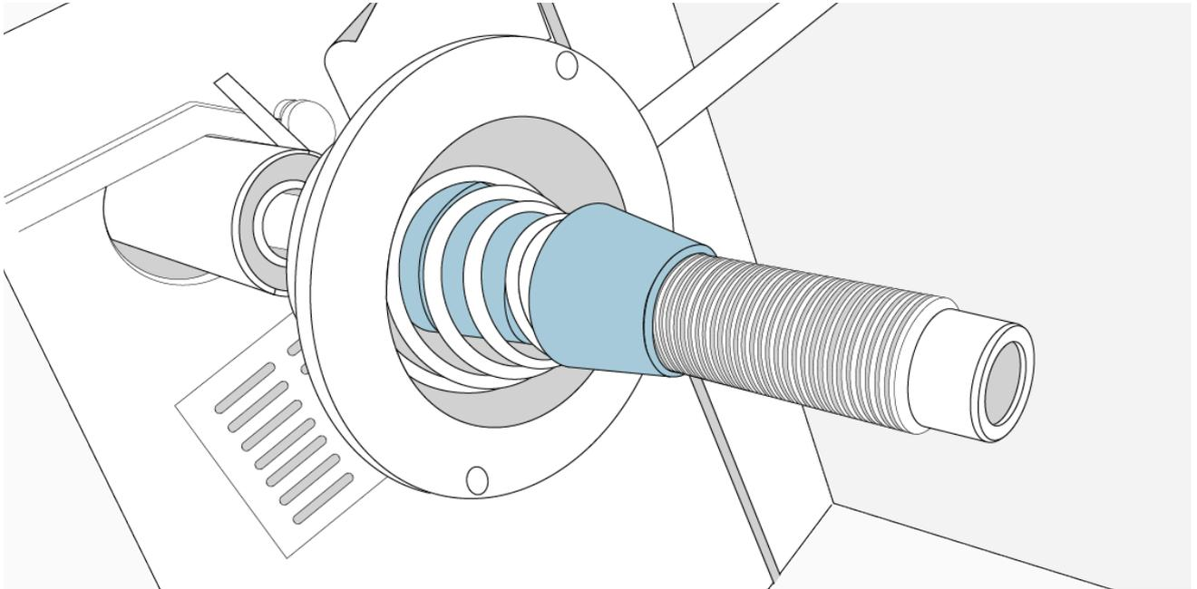
Der hintere Adapter sorgt für eine unsauberen Sitz des Reifens auf der Welle.
