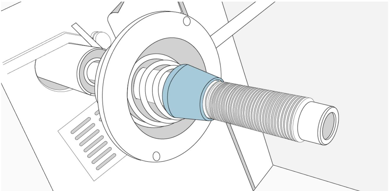
Nach dem Entfernen des vorderen Adapters und der Feder auch den hinteren Adapter abziehen.
