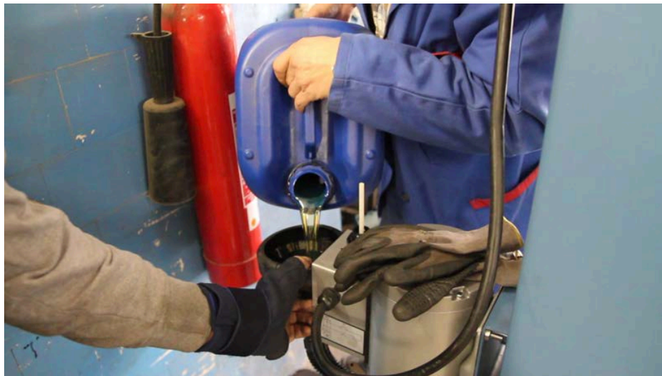
Abbildung 30: Einfüllen des Hydrauliköls.
