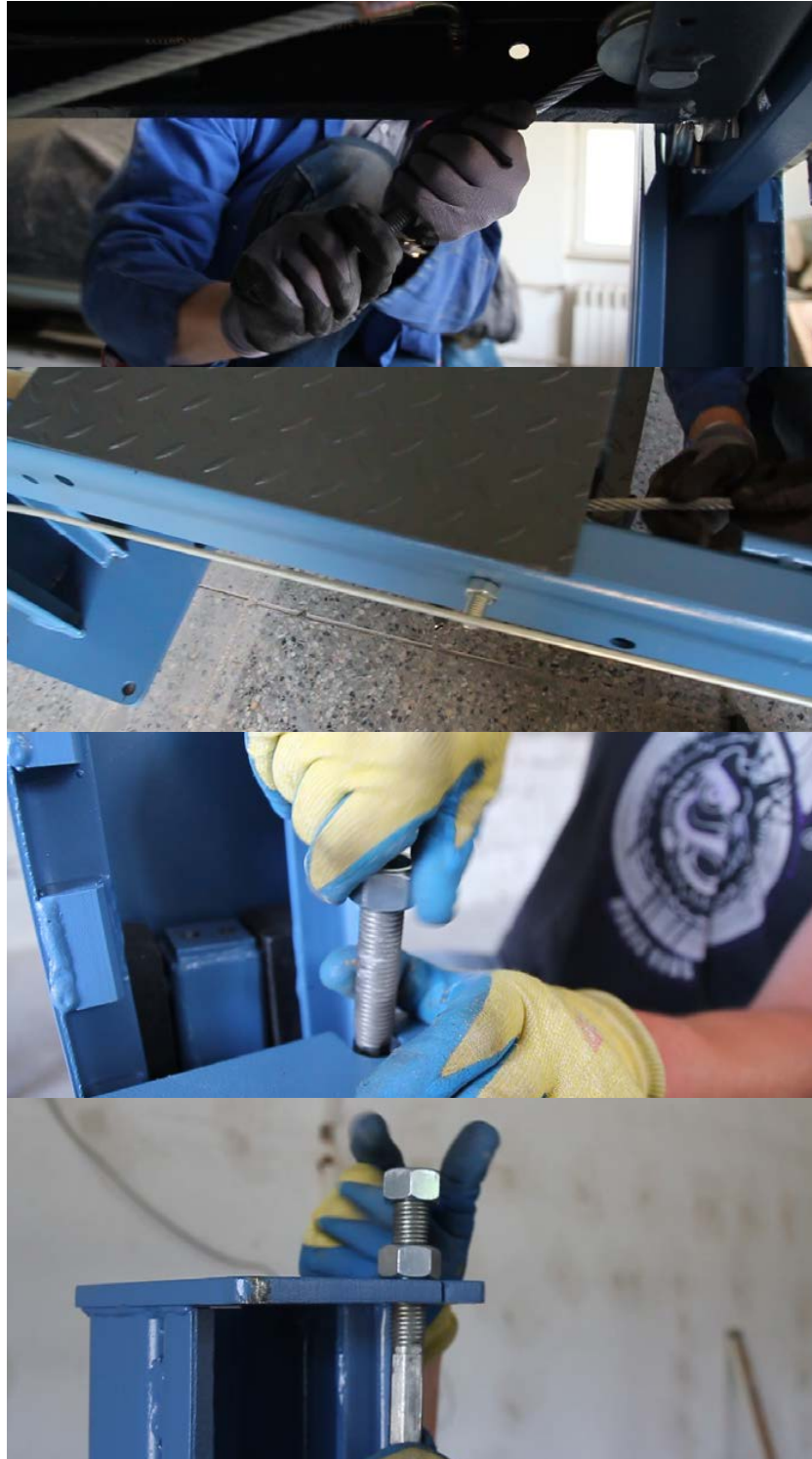
Abbildung 6: Führen Sie zuerst das Stahlseil über die untere Eckrolle
