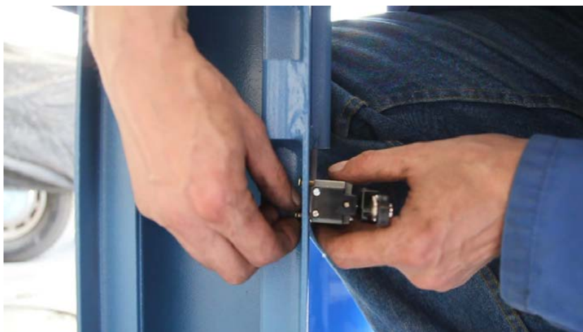
Abbildung 21: Montage der Endabschalter
