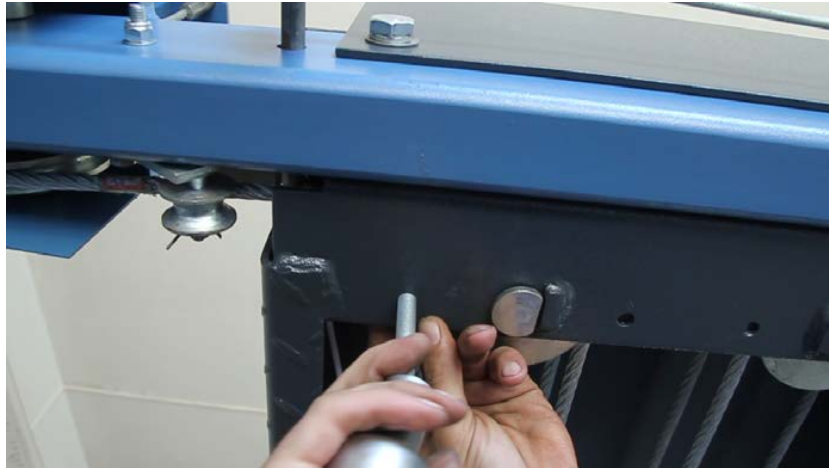
Abbildung 10: Montage der Sicherungsstifte
