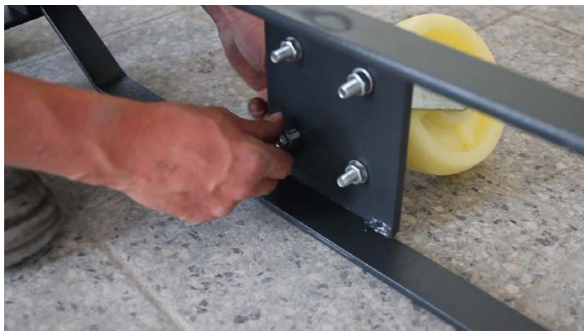
Abbildung 19: Montage des Fahrwerks
