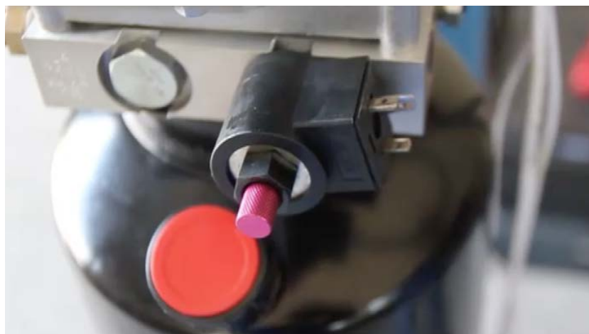
Abbildung 13: Stromdose des Bedienpultes mit Sicherheitsknopf
