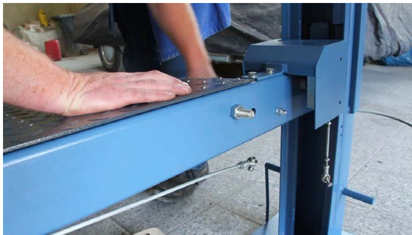
Abbildung 5: Hier wird die Fahrbahn verschraubt
