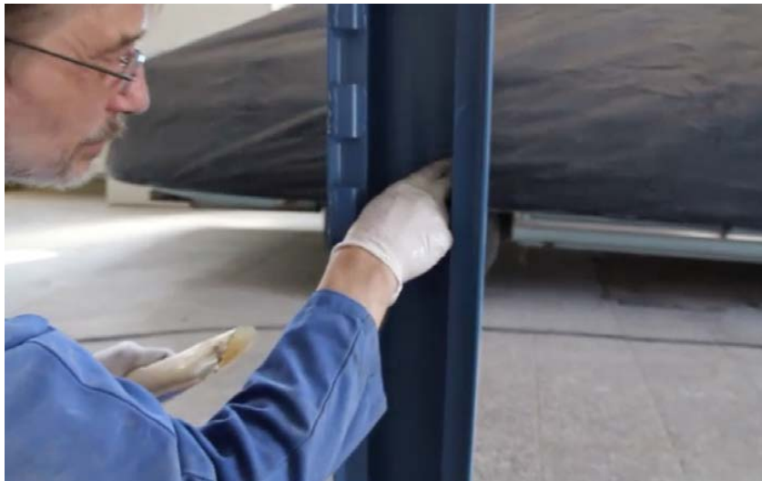
Abbildung 31: Einfetten der Ketten und des Gleichlaufseils
