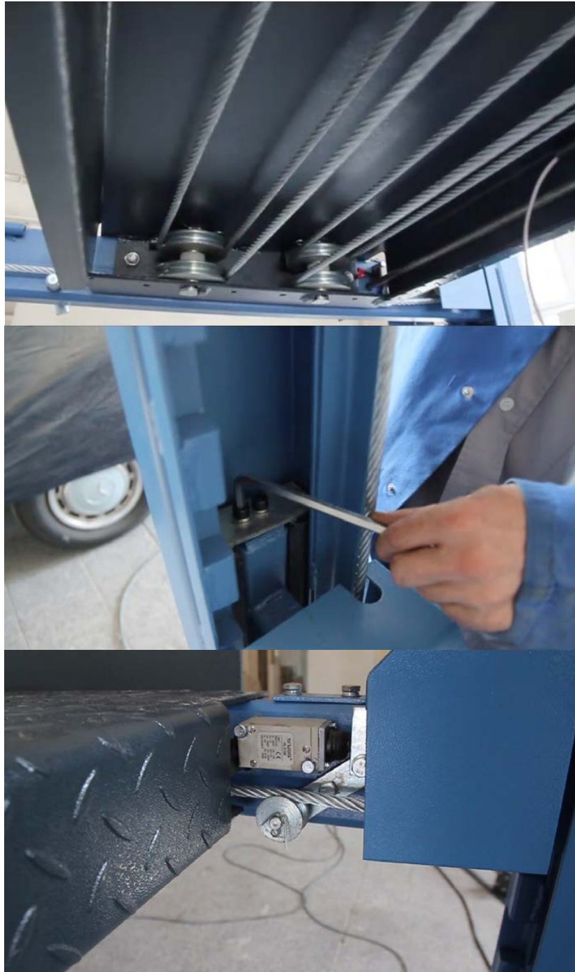
Abbildung 09: Stahlseil auf Lenkrolle.
