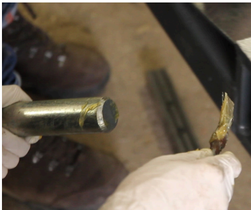
Ölen der Tragarmgelenke und der Bolzen. Abb.8.37
