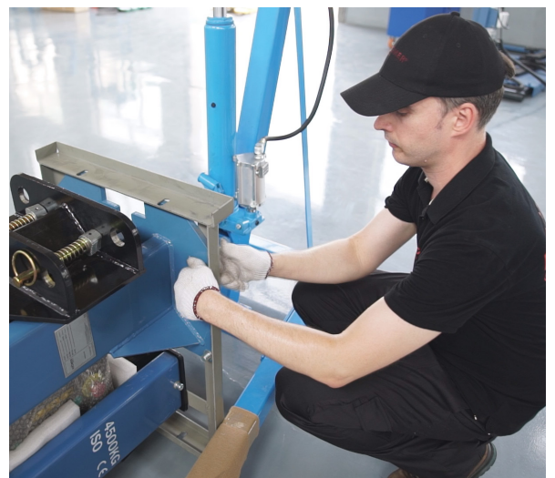
Entfernen des Schutzgerüsts
