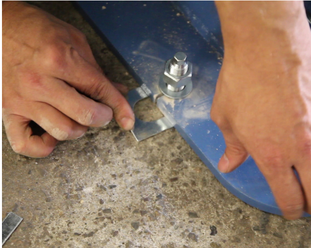
Unterlegscheiben einsetzen, wenn nötig Abb.8.11
