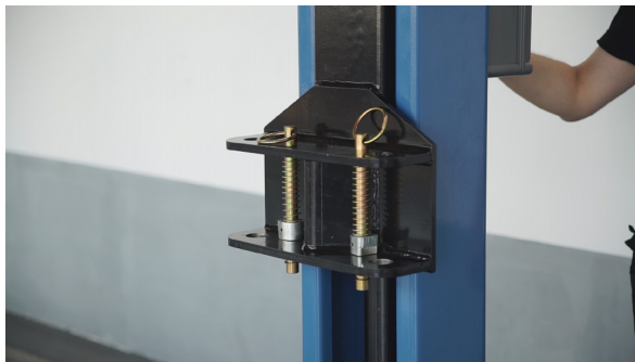
Anheben des Hubschlittens
